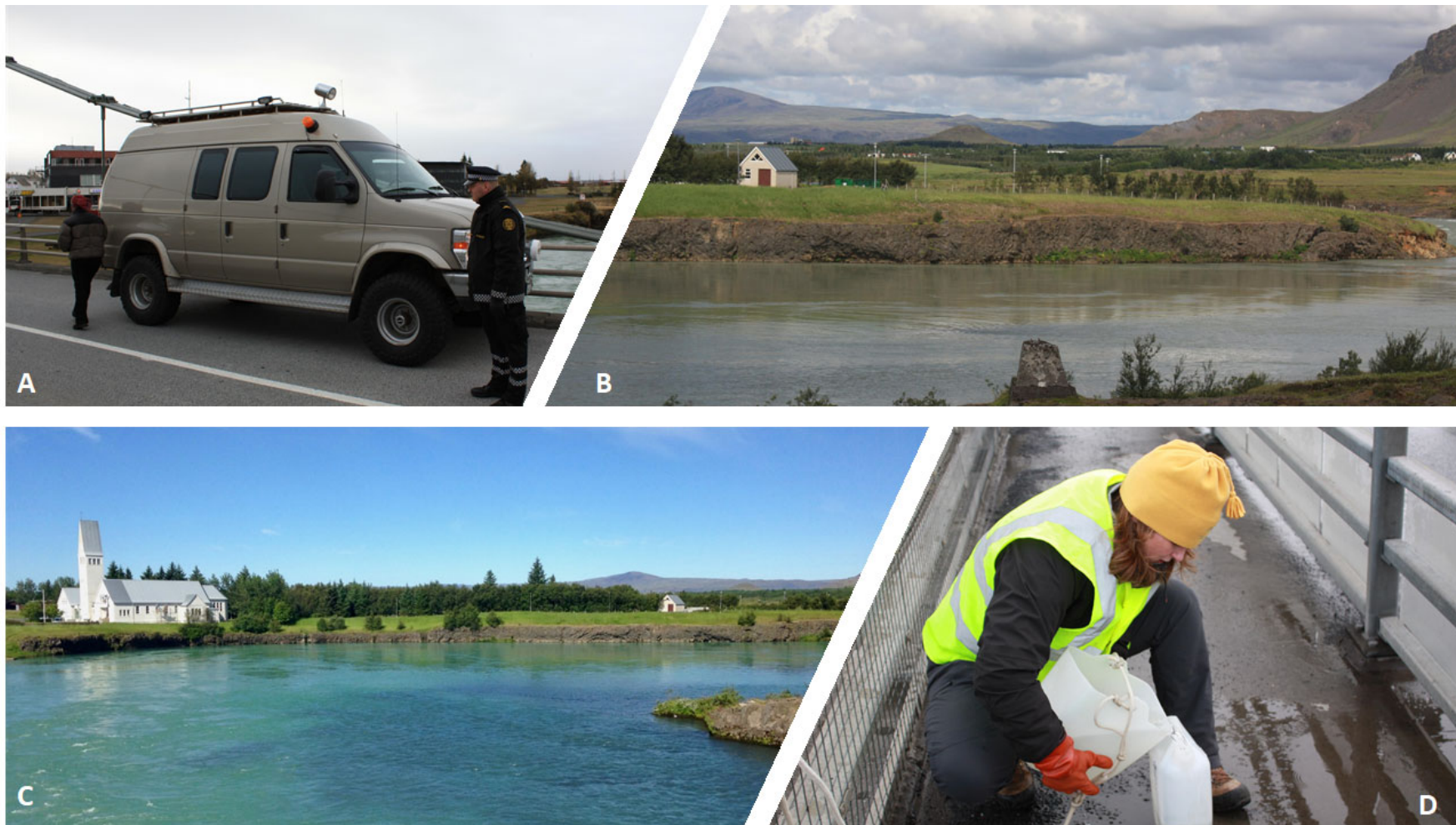
Mynd 7 A-D. Sýnasöfnun í Ölfusá 6. Júlí 2010 (B) og 10. júlí 2017 (C, mynd: Deirdre Clark). Svifaurssýnin eru tekin með svifaurssýnataka í spili og þarf aðstoð lögreglu við að stjórna umferð á meðan (A). Vatnsefnasýnin eru tekin í fötu í af brúnni við Selfoss, í djúpa hluta farvegarins (D).
