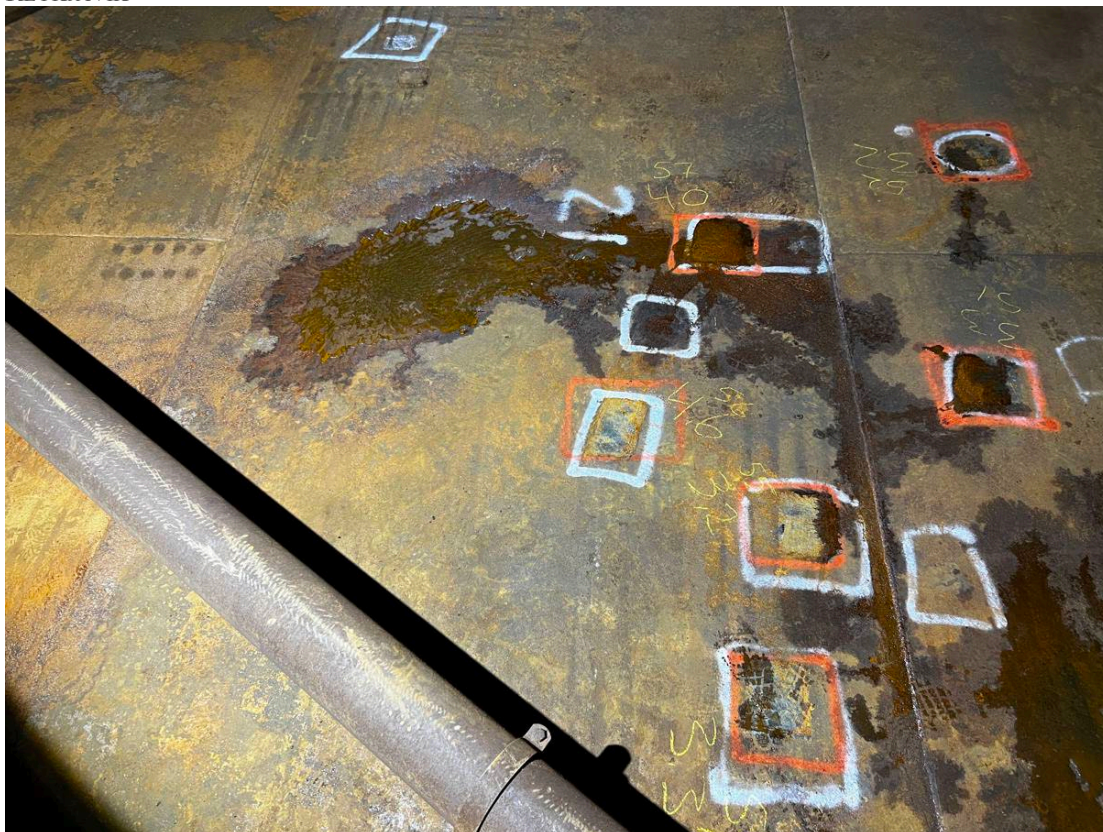
Mynd 3. Segulsviðsskanni fann fjöldamörg svæði sem skoða þurfti betur með hljóðbylgjuskanna.
