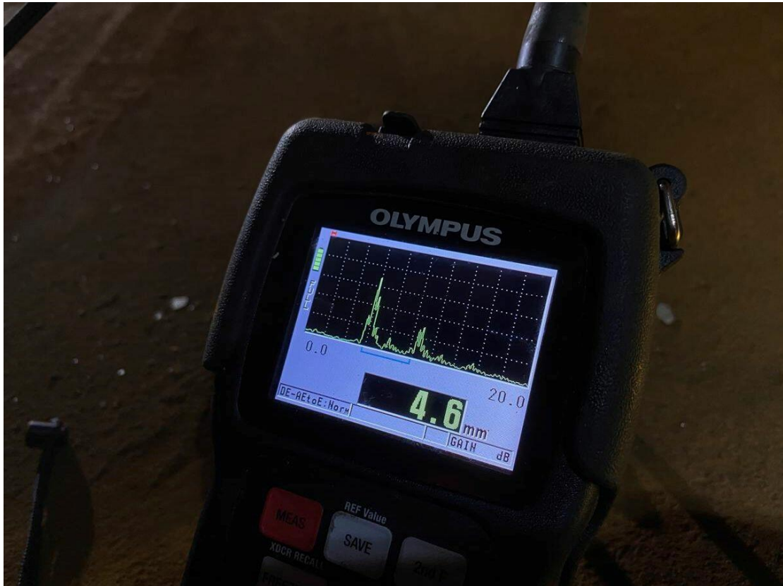
Mynd 10. Í plötu 15 fannst blettur þar sem efnisþykkt plötu er 4,6 mm.
