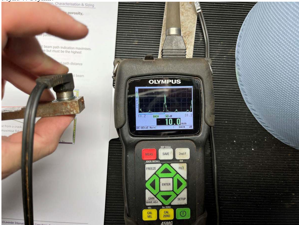
Mynd 8. Þykktarmælir prófaður og kvarðaður á kvörðunarblökk.
