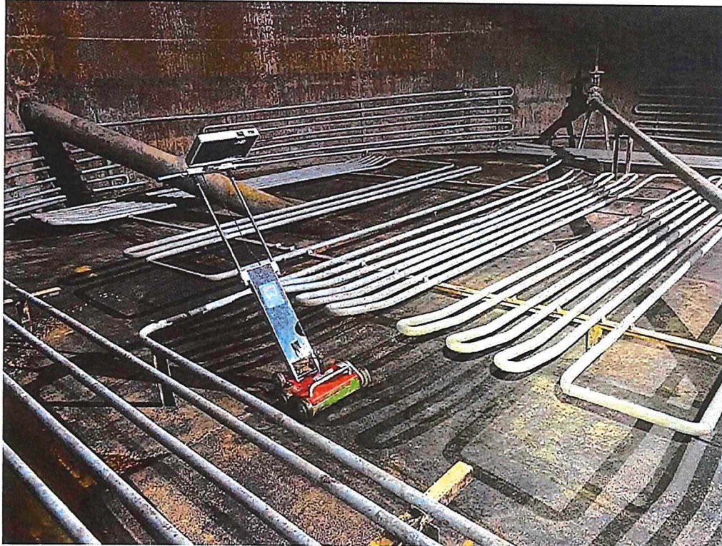
Mynd 4. Hljóðbylgjuskanni að störfum, einungis var hægt að mæla hluta af geymi vegna spírala.
