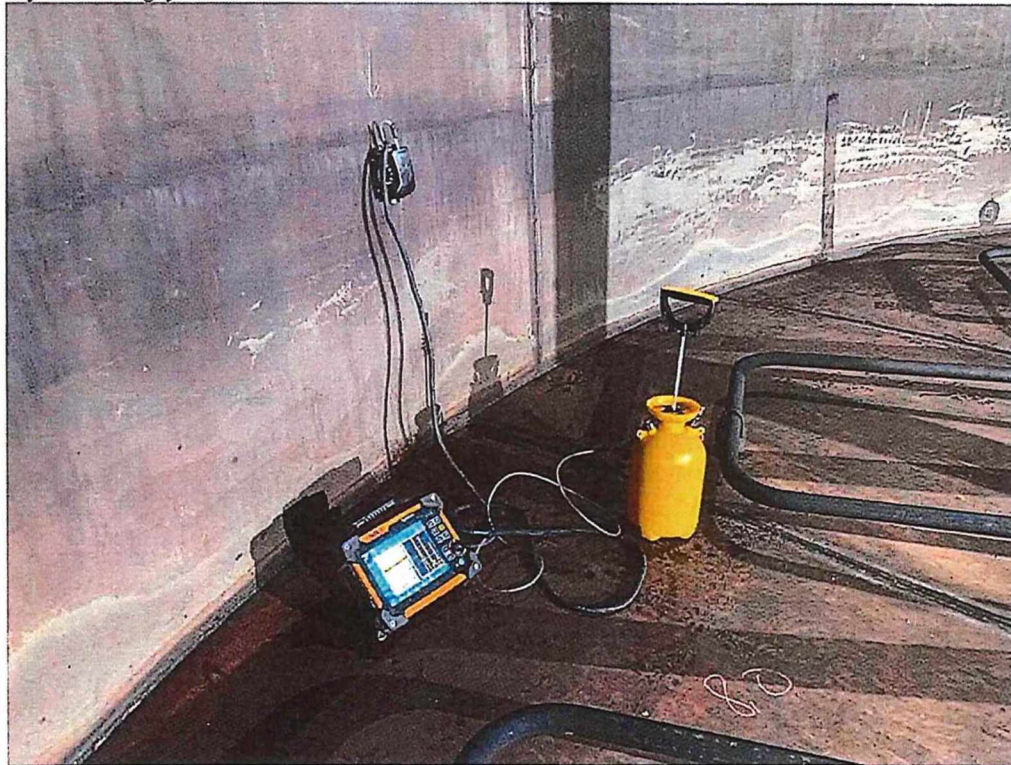
Mynd 4. Hljóðbylgjuskanni var notaður til að skoða hvort umfarið væri tært.
