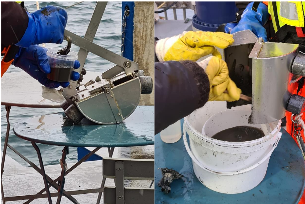
Mynd 2-2. Lokuð Van Veen greip til vinstri og opin greip með sýni til hægri.
