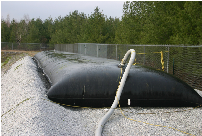
Mynd 10.7: Geotube söfnunarpoki.[28]
