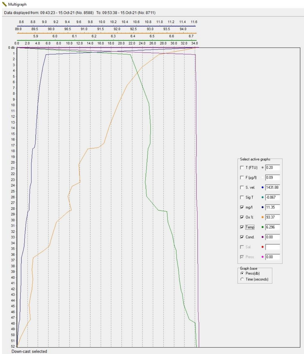
Mynd 5. Niðurstöður mælinga á salti (ppm) sem er táknað með fjólublárrí línu, hitastigi táknað er með grænni línu (°C) og súrefni þar sem bláa línan táknar mg/l og sú gula súrefnismettun sjávarins (%).
