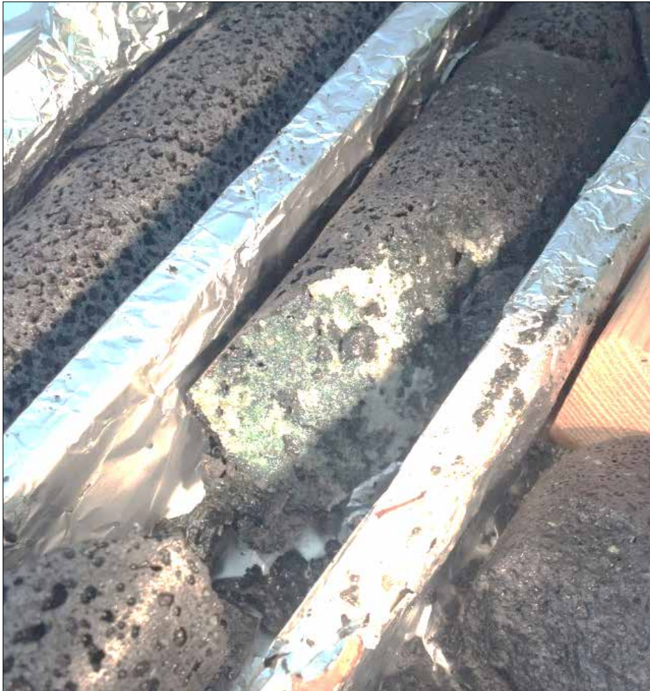
Mynd 21. Útfelling kalsíts í basaltbergglögum á tilraunasvæði CarbFix verkefnisins við Hellisheiðarvirkjun í kjölfar niðurdælingar uppleysts koltvísýrings frá virkjuninni. Ferilefni (græn sliokja) greina á milli nýrra og eldri kalsítútfellinga. Ljósmynd: Sandra Ósk Snæbjörnsdóttir.
