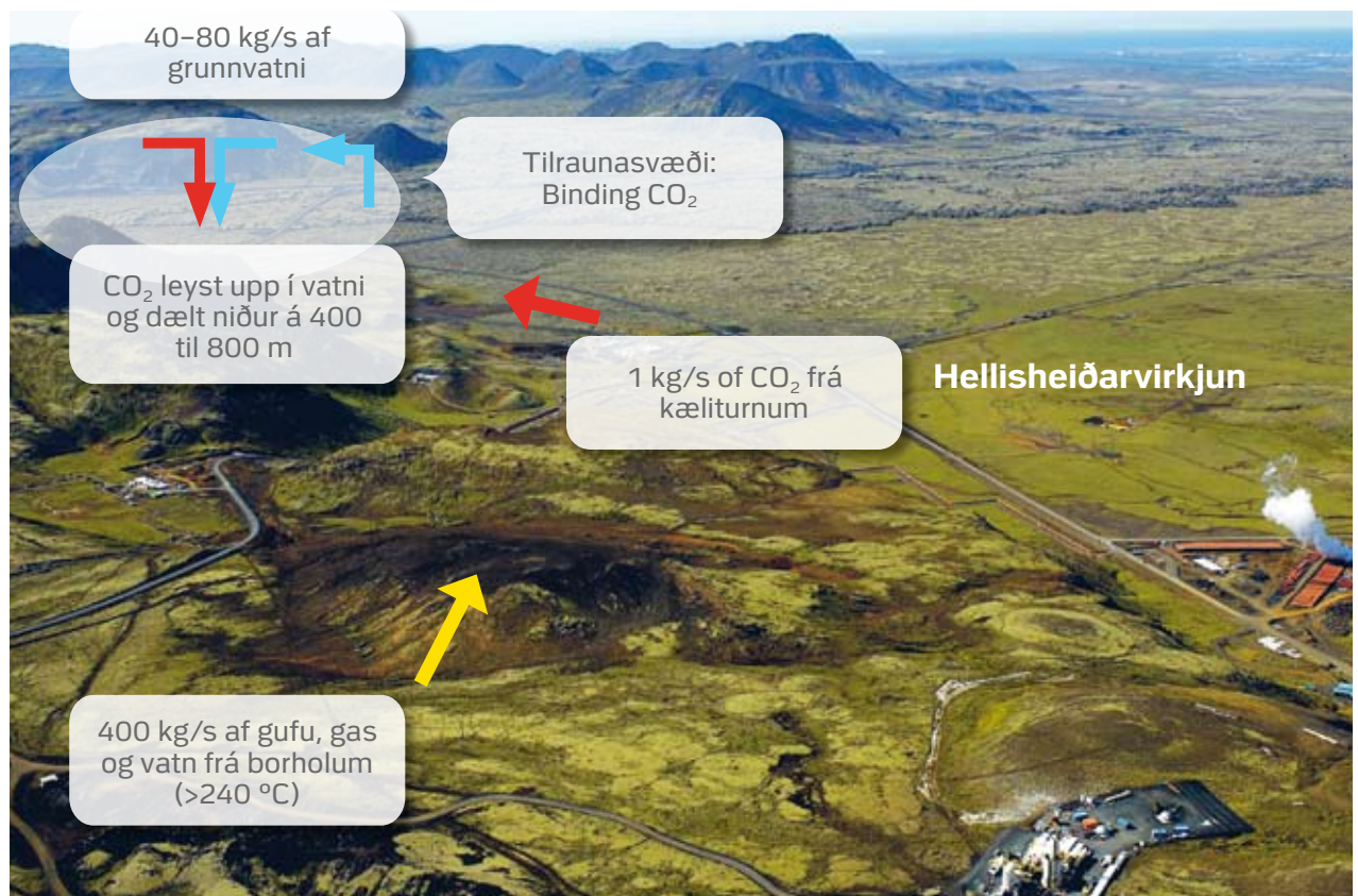
Mynd 18. Fyrirhuguð binding koltvísýring CO 2 í basalti við Hellisheiðarvirkjun. CO 2 frá virkjuninni verður leyst upp í vatni og dælt niður á 400–800 m dýpi þar sem það verður bundið í jarðlögum.
