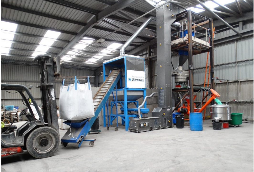
Mynd 3. Búnaður til að meðhöndla gjallsand úr saltlausiferlinu.
