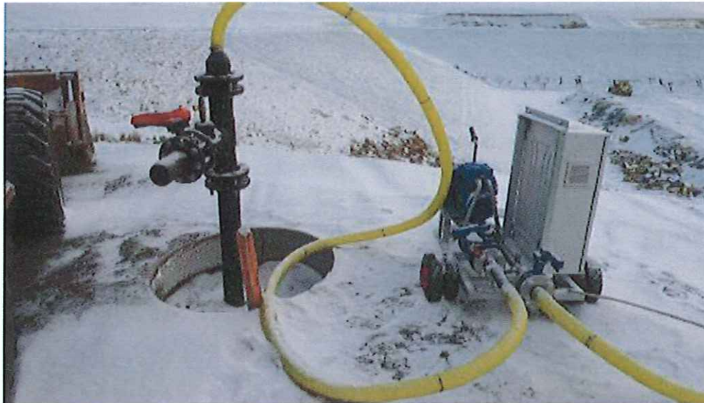
MYND 4 Gas- og afkastmælingar við holu 4. Ljósmynd AK.
