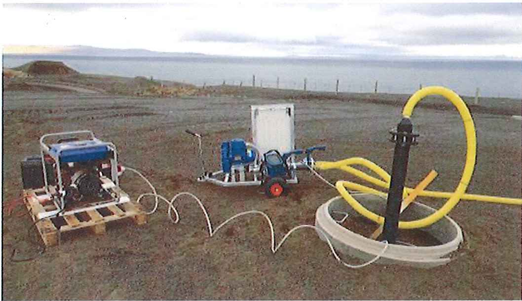
MYND 2 Gas- og afkastmælingar við holu 3. Ljósmynd AK.
