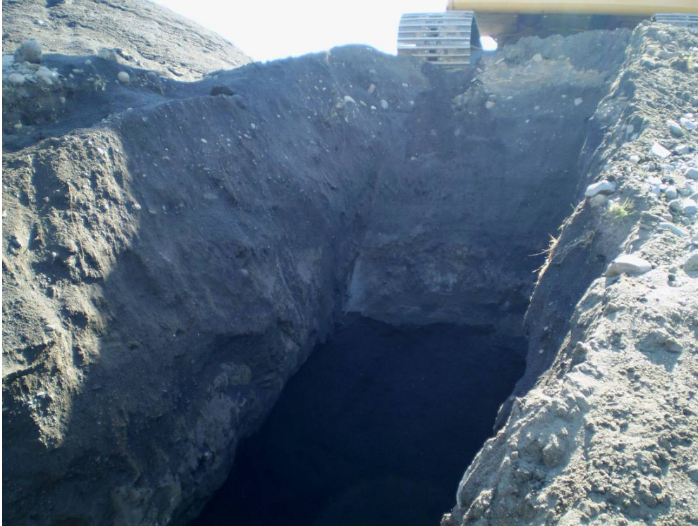
Mynd 7. Könnunarhola 2. Á myndinni má sjá að efst í holunni er um 2 – 2,5 m þykkt lag úr þéttu silti/leir. Fyrir neðan siltið/leirinn er síðna þykkt lag af ólagskiptum sandi sem er mjög laus í sér.
