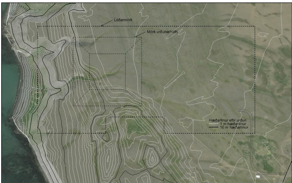
Mynd 5-16 Myndin er sú sama og 5-15 en hér er komin áætlun um hæðarlínur eins og þær verða eftir að urðun líkur á svæði. Línur í landinu eru heldur mýkri en fyrir en falla vel að umhverfinu.
